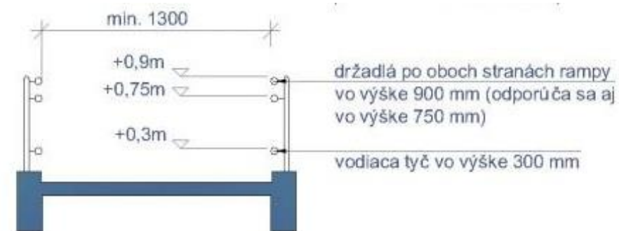
Priečný rez rampou (šírka ramena a osadenie držiadiel)
